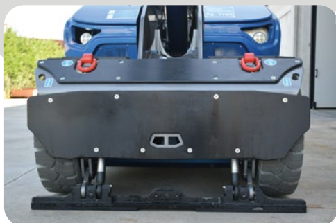
BARRA STABILIZZATRICE Stabilizer crossbar / Barre stabilisatrice Vorderradabstützung / Barra estabilizadora
